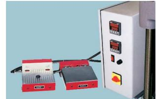
Нагреваемые плиты с цифровым управлением и отключением (в наличии с каналами охлаждения)
