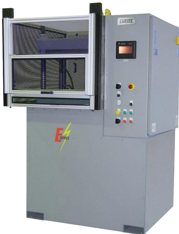
Характеристики: датчик нагрузки для отражения усилия; PLC управляет функциями прессы; Сегментированная программа с сохранением рецептуры; Так-скрин интерфейс оператора; Пластины в наличии до 18" x 18"; Защита зоны зажима; Запатентовано (US 6990896B2).
